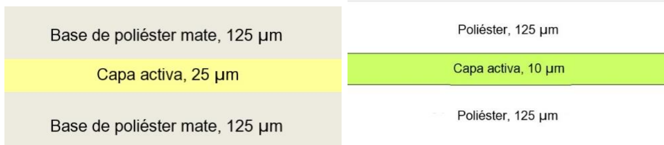
Figura 1. Comparación de la estructura de la PRC EBT-XD (13) vs MD-V3 (14).
