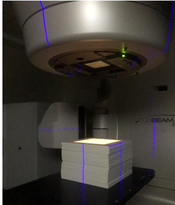
Figura 8. Arreglo experimental con el acelerador lineal TrueBeam de 6 MV, las placas de maniquí de agua sólida y las muestras de PRC en el maniquí.
